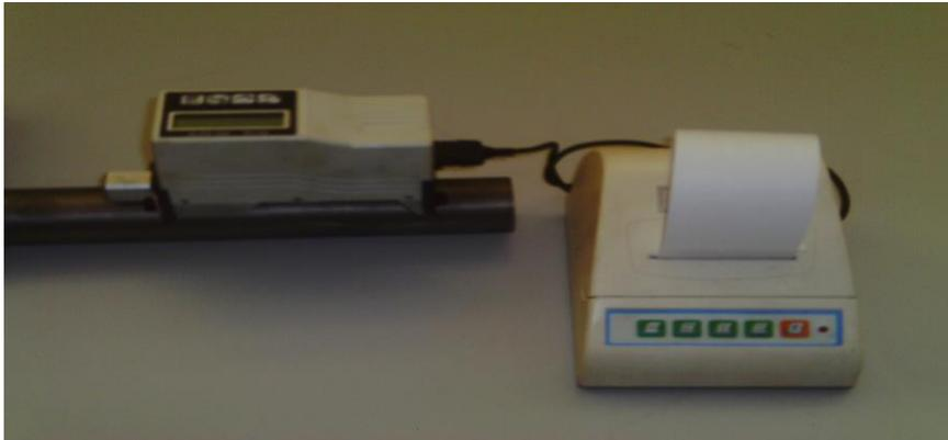
شكل رقم (1) جهاز مقياس خشونة الأسطح
